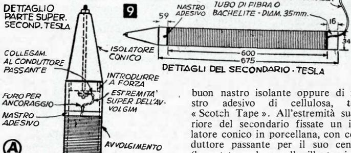
buon nastro isolante oppure di nastro adesivo di cellulosa, tipo « Scotch Tape ». All'estremità superiore del secondario fissate un isolatore conico in porcellana, con conduttore passante per il suo centro (le potete vedere nelle illustrazioni)
